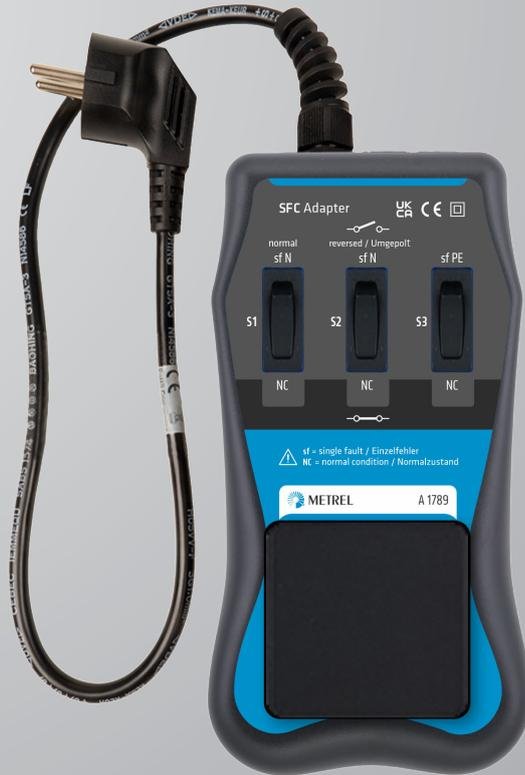
Der Adapter für die Bedingung eines Einzelfehlers wurde entworfen, um abnorme Betriebsbedingungen oder Einzelfehlerbedingungen (SFC) zu simulieren. Produktnormen wie z. B. EN 60601 und EN 62368 erfordern Prüfableitströme in der Einzelfehlerbedingung. Der Adapter wurde für den Betrieb mit Master-Geräten entworfen, die Parameter der Einzelfehlerbedingung unterstützen, wie z.B. Geräte aus der Reihe MI 3360.
